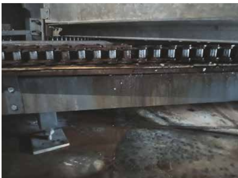
Obr. č. 6: řetězový převod pohonu bubnu dopravního pásu.
